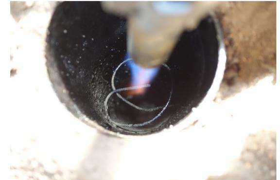
煙道 熱電対を直接バーナーで加熱してセンサー異常チェックを実施したが、360℃まで上昇し、外気温まで正常に復帰した。→ センサー異常なく、実際に煙道部の温度が上がっていなかったと判断
