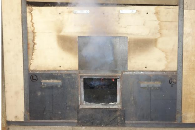
精錬 前蓋全開 直後。今回、煙道温度が何故か低く、煙突の引きが不足し、30分程 煙や炎のバックフロー（焚き口から出る）が続いた 一旦、全面蓋を30分程、再度 閉じてから全開した。
