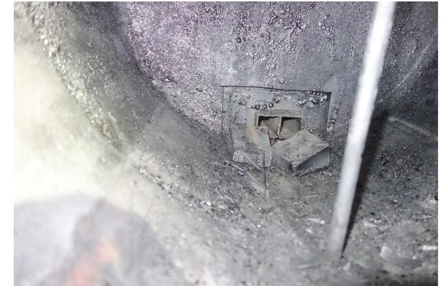
ロストルを引き出し時に竹炭と一緒に引っ張り出されたと思われるが、右側レンガが手前側に移動していた。この状態は 煙道入口を広める方向での変化で、セットした状態より煙道への出口が更に狭められ、煙道温度が上がり難かった との仮説とは、逆の結果であった→ 煙道部の温度が上がっていなかった 原因不明
