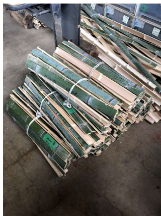
竹割し束(10Kg前後)にして 乾燥開始 束毎に重量変化をチェック
