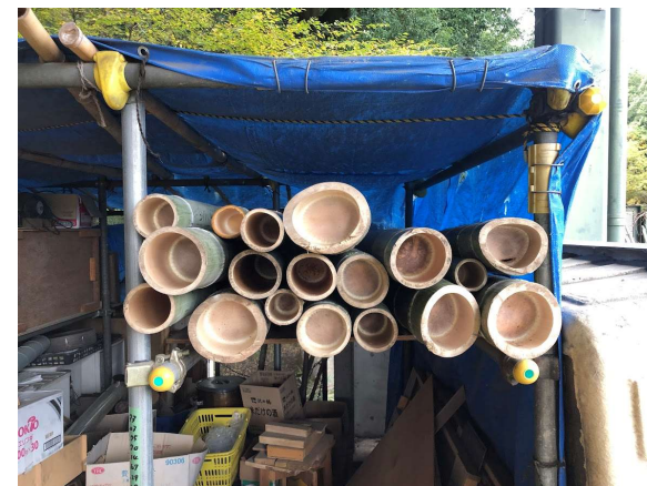
3m長寸のまま乾燥開始 長寸状態 での重量 5~20Kg/本
