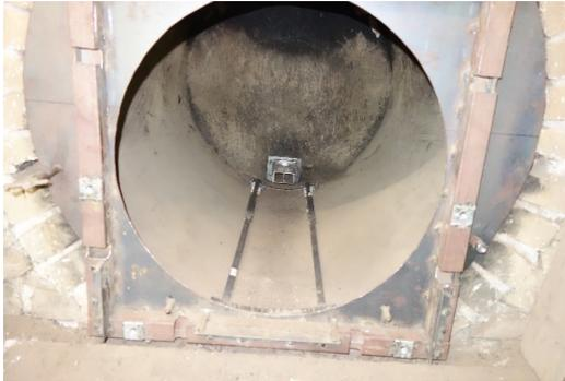
既設大型SUS缶内へのドラム缶を精度良く設置する為のガイド機構
