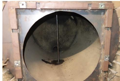
窯上部から熱電対を挿入す為の穴あけ加工後、窯内にセットされた熱電対入りSUS管
