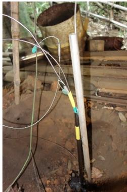
窯上部から 熱電対3本を仕込んだSUS管(13φ)設置状況
