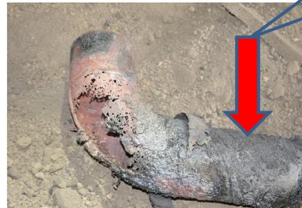
4月に先行解体した右側窯のエビ管 劣化状態。次ページに4月の解体状況をまとめた2枚のスライドを再掲載
