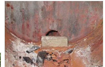
煙道への入り口を絞って、炭化速度を抑え、じっくり炭化を進める (高さ60→26mm)
