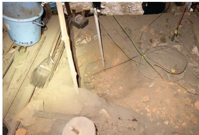
窯上部から熱電対を挿入する場合の挿入位置
