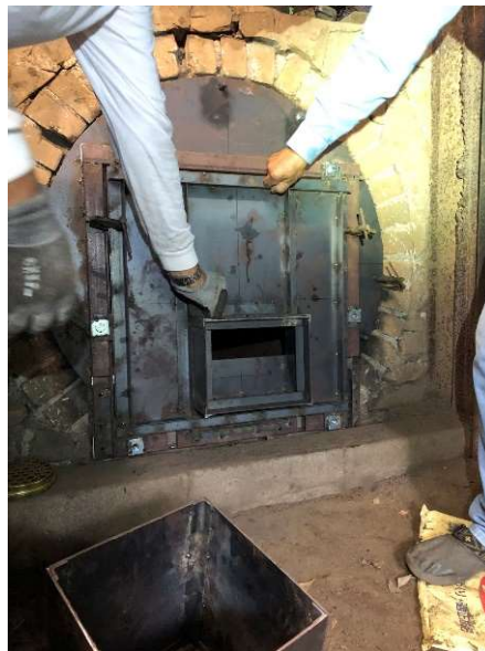
2分割し、軽量化した前面蓋(その2) この部分を脱着し、炭材入れ と炭取り出しを行う
