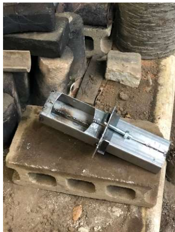
既設の大型缶と内側にセットするドラム缶の煙道をつなぐ部品
