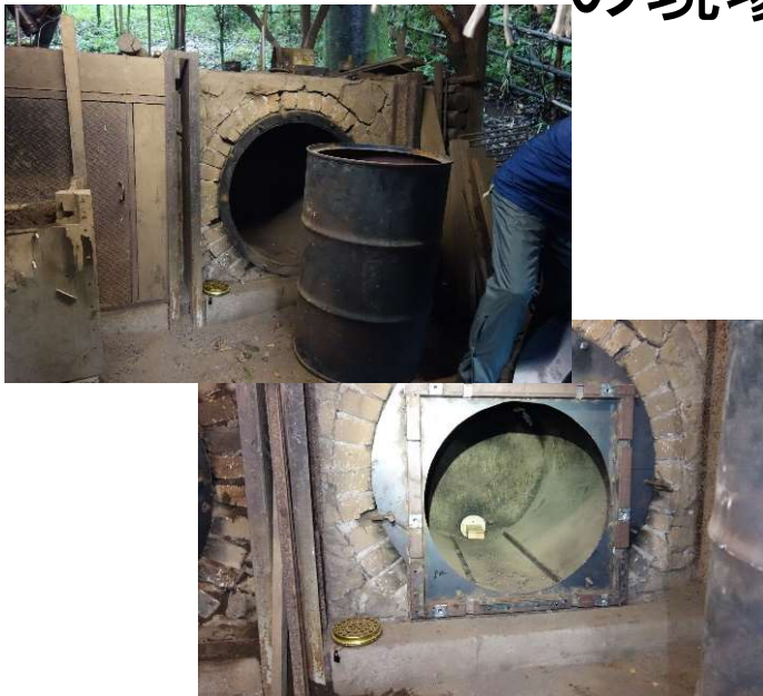
既設大型缶とドラム缶、2分割し、軽量化した前面蓋(その1)
