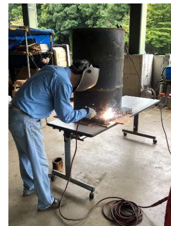
前面蓋(その1)とドラム缶を溶接を開始
