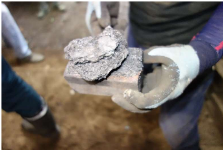
煙道への入り口を絞ったレンガに付着した炭化物と 窯内に残った炭化物(デブリ)
