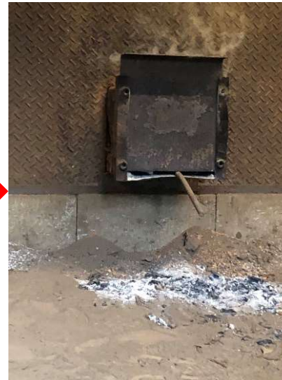
自発炭化中、竹酢液回収。焚き口が変形、スキが一樣になる場所へ丸棒を移動
