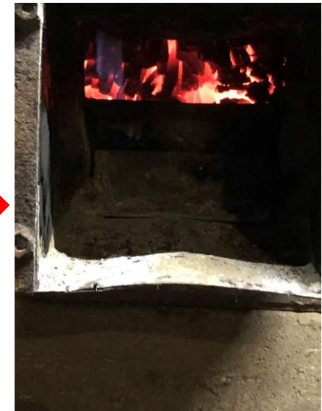
精錬開始 窯内温度 急上昇、ブルーフレーム 長時間出現し、窯内769°まで上昇
